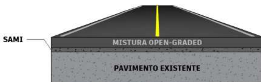
Figura 33 - Seção transversal das soluções propostas
